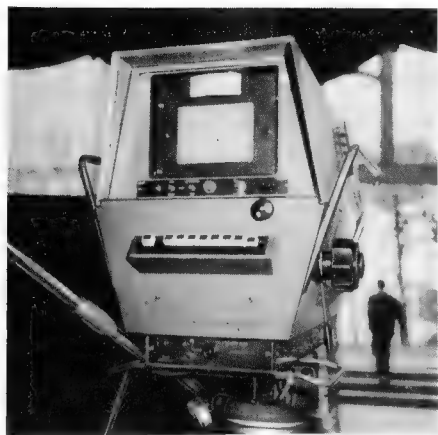
Bild 2. Transistorisierte französische Studiokamera für drei Normen mit 4 1/2-Zoll-Image-Ortikon und 17-cm-Bildröhre für den elektronischen Sucher (Bedienungsseite)
