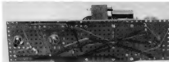
Links: Bild 1. Die Chassisplatte ist mit einer Anzahl von Hohl-nieten versehen, die als Lötstützpunkte dienen. Die Verdrahtung ist dadurch einfach und übersichtlich
